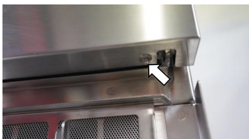
1. 拆下门底部的两个 M4 x10 六角头法兰螺栓。
