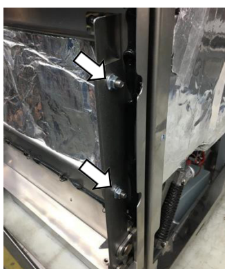
4. 从门铰链松开并拆下四个 M5 法兰锁紧螺母和 M5 六角头螺栓
