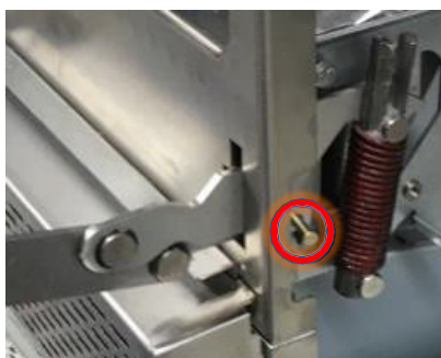
5. 打开门并将锁销安装到位，以防止铰链弹回。
